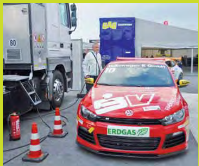
An den Tankwagen der GasCom Equipment GmbH können – wie hier am Hockenheimring – zwei Rennwagen gleichzeitig mit BIO-ERDGAS betankt werden. Ein Kompressor hinter dem Fahrerhaus sorgt gleichbleibend für 220 bar Druck.
